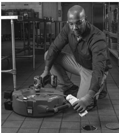
Obrázok 13 – Nanášanie maziva na plášť kábla
