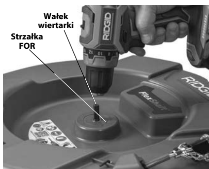
Rysunek 4 – Mocowanie wiertarki na wale wiertarki
