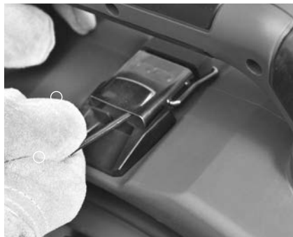
Obrázek 14 – Otevření západky pod nosnou rukojetí (použijte imbusový klíč)
