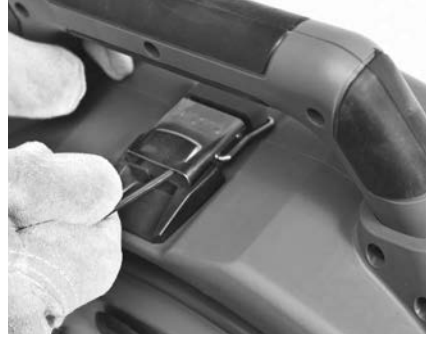
Şekil 14 - Taşıma Sapının Altındaki Mandalı Açın (Altıgen Anahtar Kullanın)
