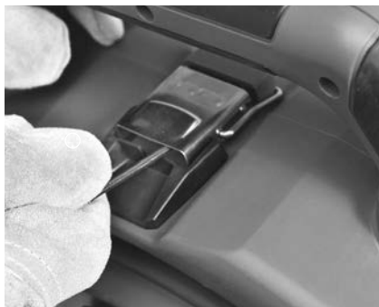
Figur 14 - Åpne låsen under bærehåndtaket (bruk sekskantnøkkel)
