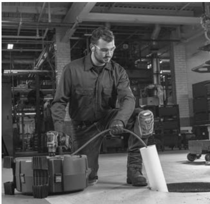
Kuva 5 – Esimerkki viemäriaukon pidentämisestä 3' päähän koneen jousiaukko
