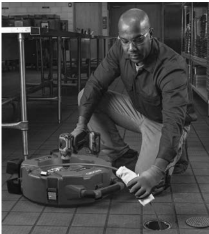
Figuur 13 – Smeermiddel aanbrengen op de veermantel
