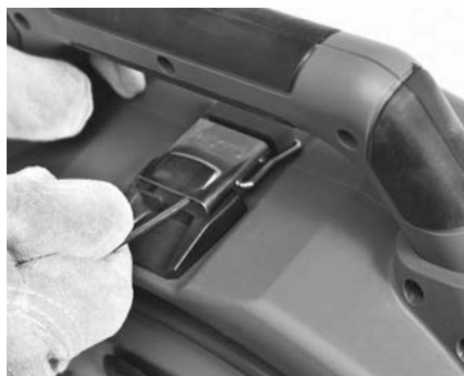
Figur 14 – Öppna spärren under bärhandtaget (använd sexkantsnyckeln)
