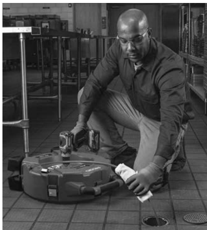
Slika 13 – Nanošenje maziva na oblogu sajle
