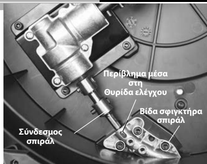
Εικόνα 16 – Αλλαγή του συγκροτήματος σπирάλ
