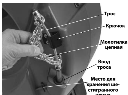
Рис. 1С - Конец троса/Цепная молотилка
