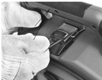
Εικόνα 14 – Ανοίξτε την ασφάλιση κάτω από τη λαβή μεταφοράς (χρησιμοποιήστε κλειδί Άλεν)
