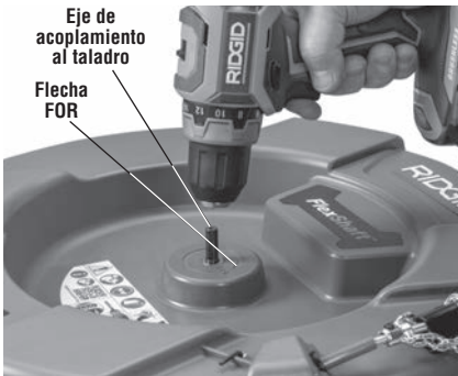
Figura 4 – Conexión del taladro al eje de acoplamiento
