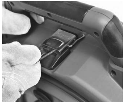
Figura 14 – Abrir o fecho por baixo da pega de transporte (utilizar chave hexagonal)
