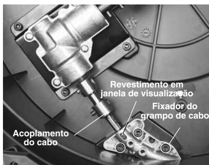
Figura 16 – Substituir o conjunto do cabo
