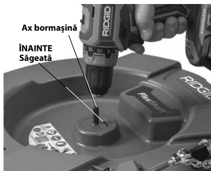
Figura 4 – fixarea bormașinii pe axul acesteia
