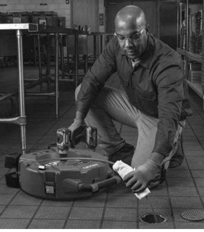
Şekil 13 – Kablo Kılıfına Yağlama Maddesi Uygulama
