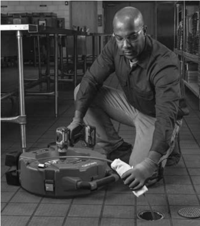
Obrázek 13 – Aplikace maziva na kabelové pouzdro
