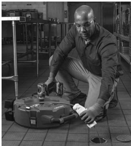
Figura 13 – Ungerea manșonului cablului
